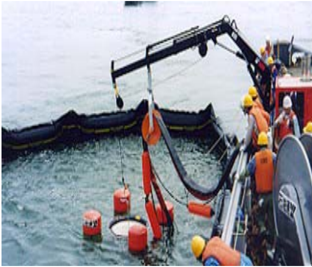
Figura 41. Introducción de skimmer dentro de la barrera flotante
