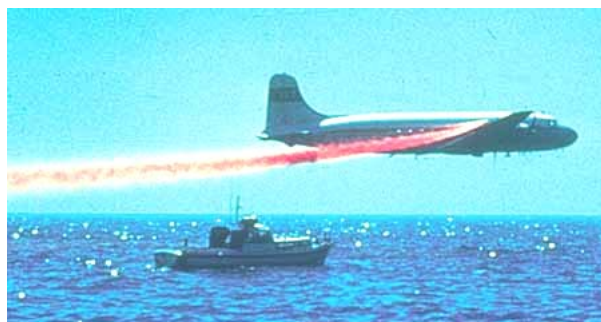
Figura 33. Aplicacion mediante aeroplano del dispersante sobre el derrame de crudo.
